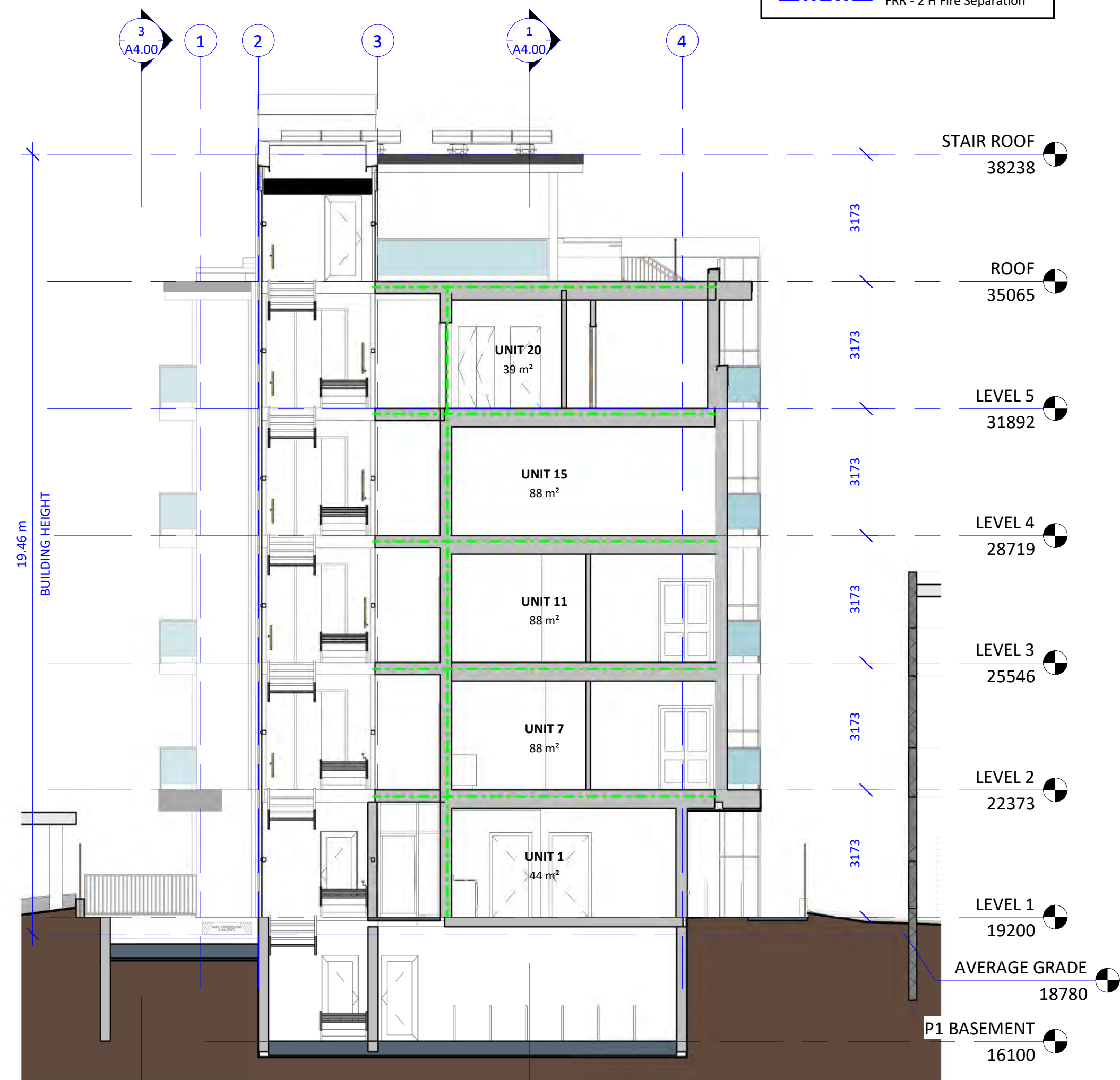
2 Section - Cross Section 1 : 100
